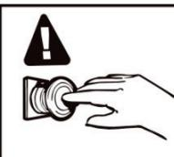
緊急時の装置の停止方法と、遮断箇所について把握しておくようにしてください。
