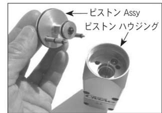
ピストンアッセンブリーをピストンハウジングに挿入します。すべてのO-リングを、41-4458 PTFEベースの潤滑剤(O-リングリペアキットに付属)で適切に潤滑してください。
