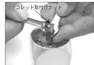
コレットロックナットを装着し、もう1本の5/16 ㇵレンチを用いて「本締め」します。
