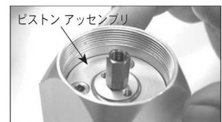
ピストンアッセンブリーは、ピストンハウジングの底(ピストンハウジングの頂部から約5/8 ㇵ)に当たるはずです。
